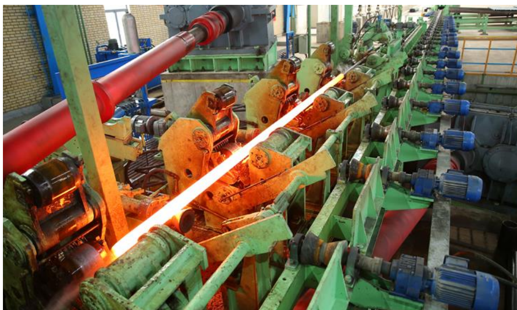
تصویر شماره 7: نمایی از تولید لوله فولادی بدون درز به روش نورد گرم
